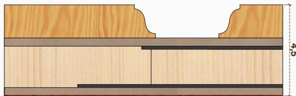
Con la opción PBM, tenemos un grueso total de 4,4-4,5 cm, con mecanizado de corte de plancha a una cara para el cajeadado de cerradura.
